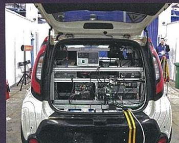
У Kia — один из самых маленьких багажников, но его как раз хватило на размещение аппаратуры автономного вождения. Энергосистема расположена в нише запасного колеса — это два аккумулятора суммарной емкостью 600 А·ч, которые заряжаются от сети 220 В. Этажерка над аккумуляторами состоит из блоков обработки данных от лидаров и камер, планирования траектории, построения «модели проходимости» и машинного обучения
