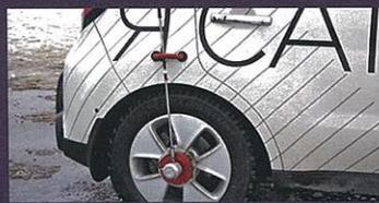
Внешний одометр установлен на одном из ведомых колес — чтобы исключить погрешность из-за возможной пробуксовки
