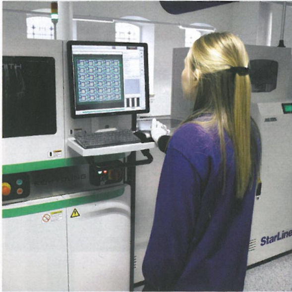
Современное оборудование и стопроцентная 3D-инспекция каждого этапа производства обеспечили практически полное отсутствие отпадов
