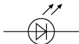
Рисунок 45. Условное изображение светодиода на схеме
