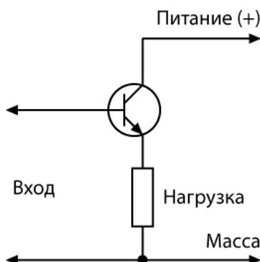
Рисунок 56. Схема включения биполярного транзистора «общий коллектор»
