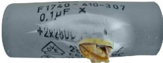
*Рисунок 30. Взорвавшийся конденсатор*
