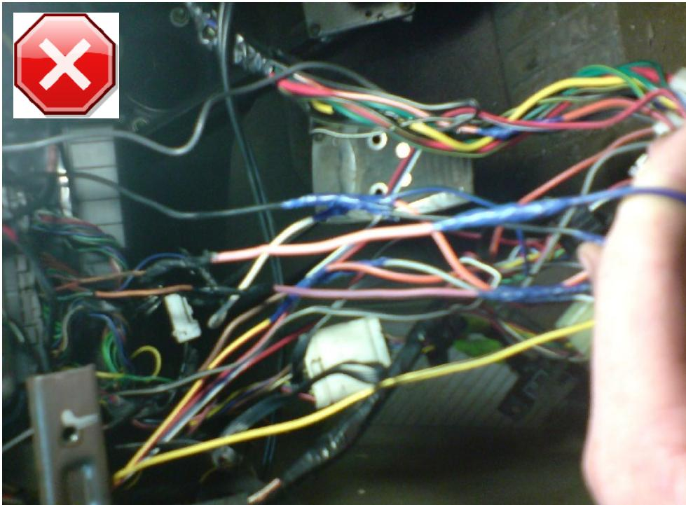
Рисунок 122. Провода без жгута
