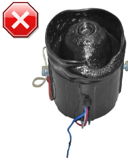
Рисунок 133. Оплавленная сирена
