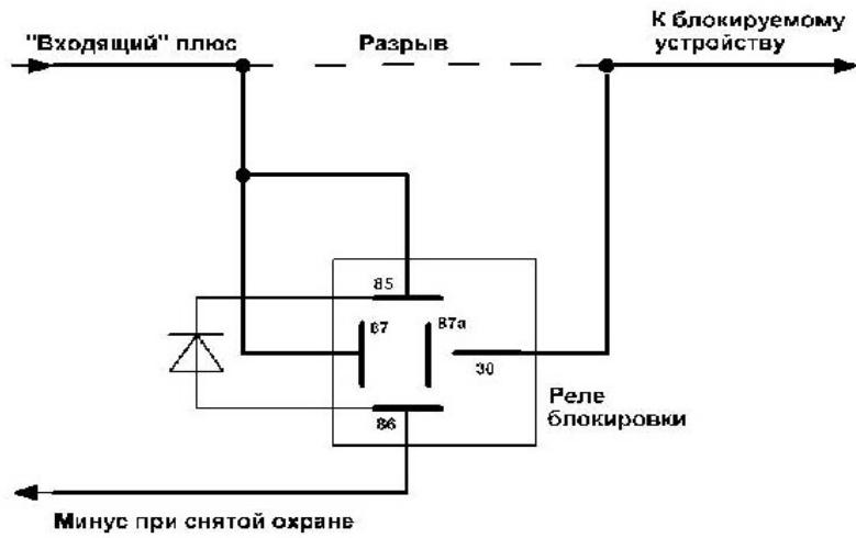
Рисунок 110. Блокировка "Минус при снятой охране"
