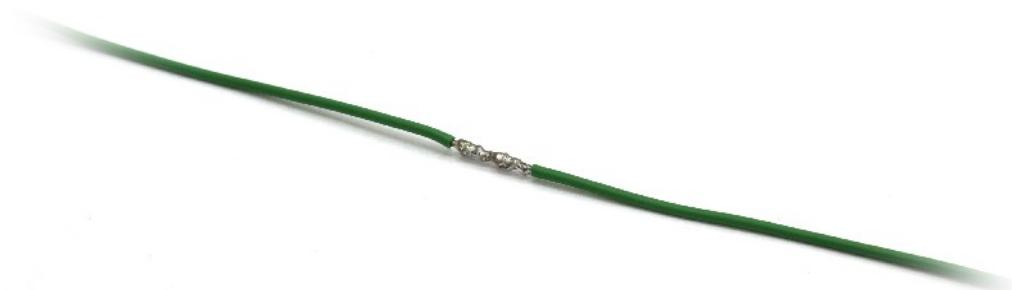
*Рисунок 153. Пайка проводов*
