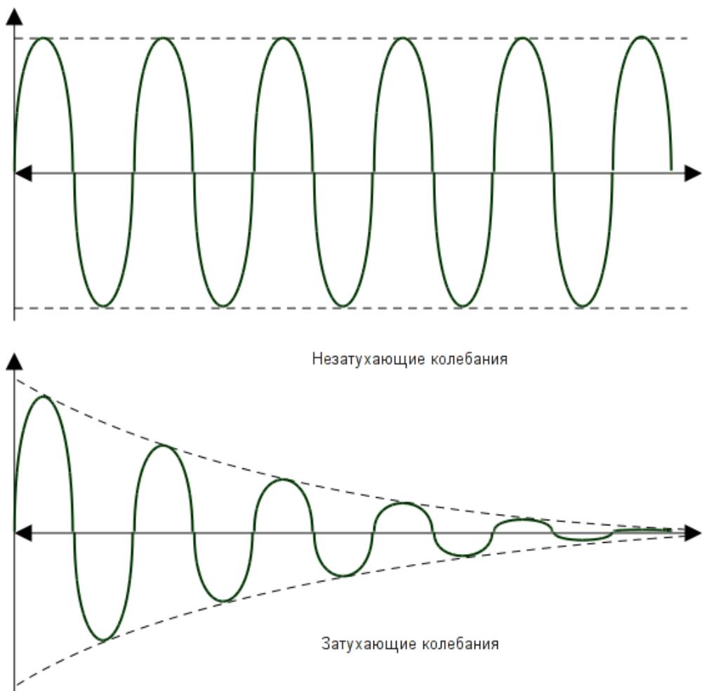
Рисунок 73. Незатухающие и затухающие колебания в контуре
