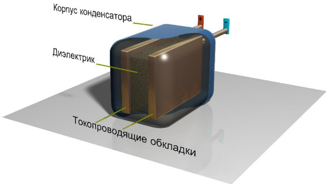
*Рисунок 25. Устройство конденсатора*
