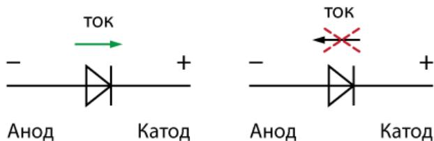
*Рисунок 40. Диод пропускает ток только в одном направлении*
