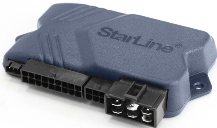
Рисунок 82. Центральный блок сигнализации StarLine B92
