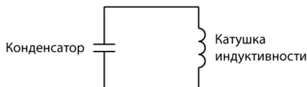
Рисунок 72. Колебательный контур
