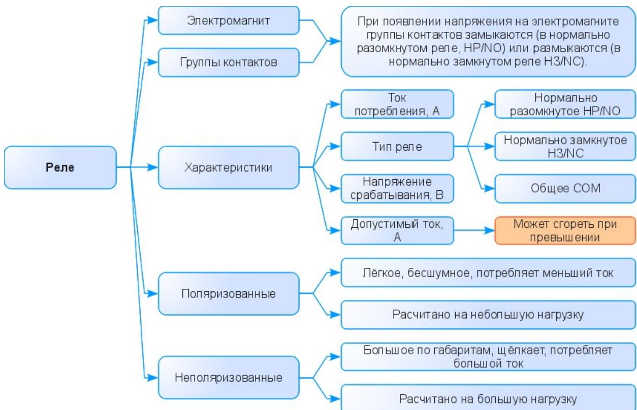
Рисунок 71. Схема-подсказка "Реле"
