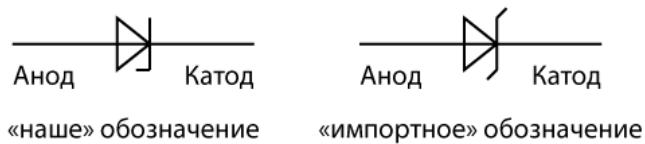
*Рисунок 42. Условное изображение стабилитрона на схеме*
