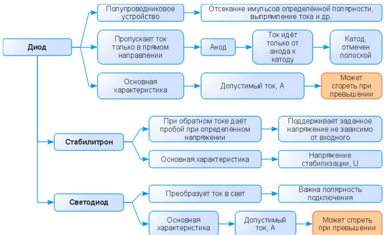
Рисунок 49. Схема-подсказка "Диод"
