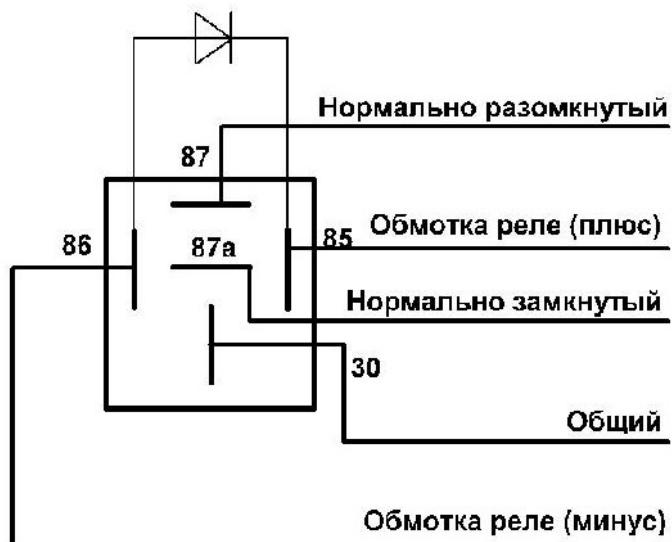
*Рисунок 109. Реле блокировки*
