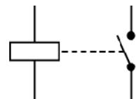
Рисунок 61. Условное обозначение реле
