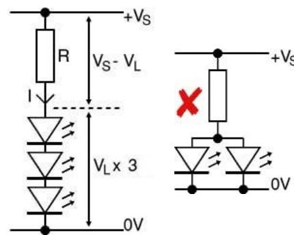
Рисунок 48. Правильное и неправильное подключение светодиодов
