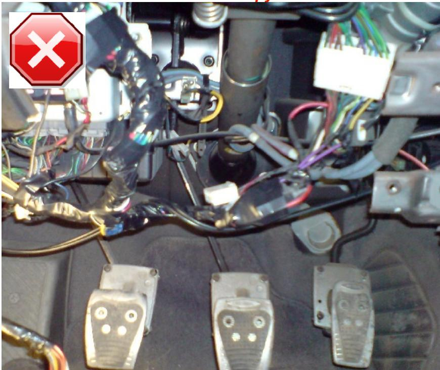
Рисунок 124. Незакрепленные провода
