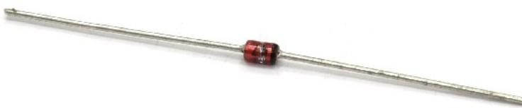
Рисунок 44. Миниатюрный стабилитрон в стеклянном корпусе
