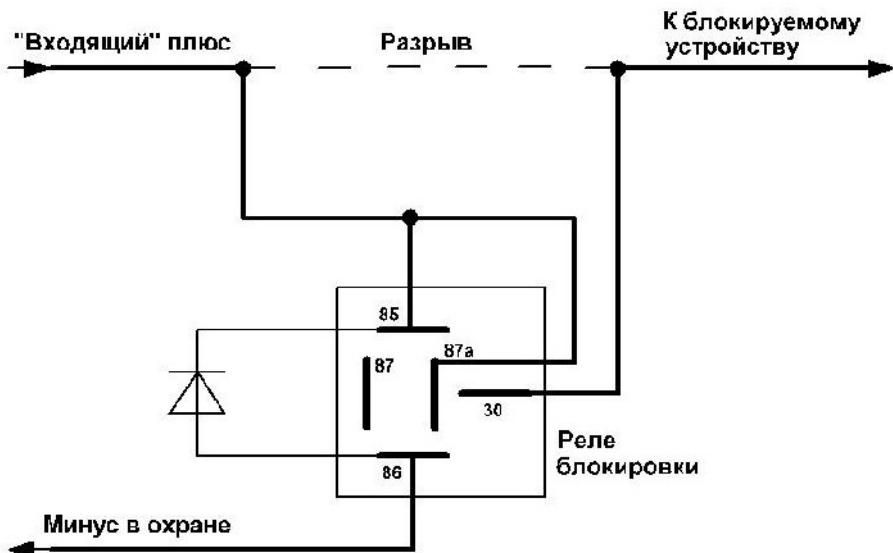
Рисунок 111. Блокировка «Минус в охране»
