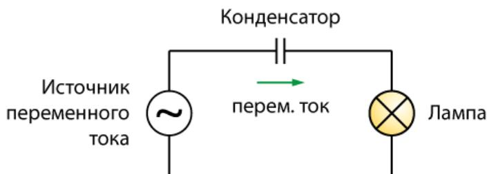
Рисунок 27. Конденсатор и переменный ток
