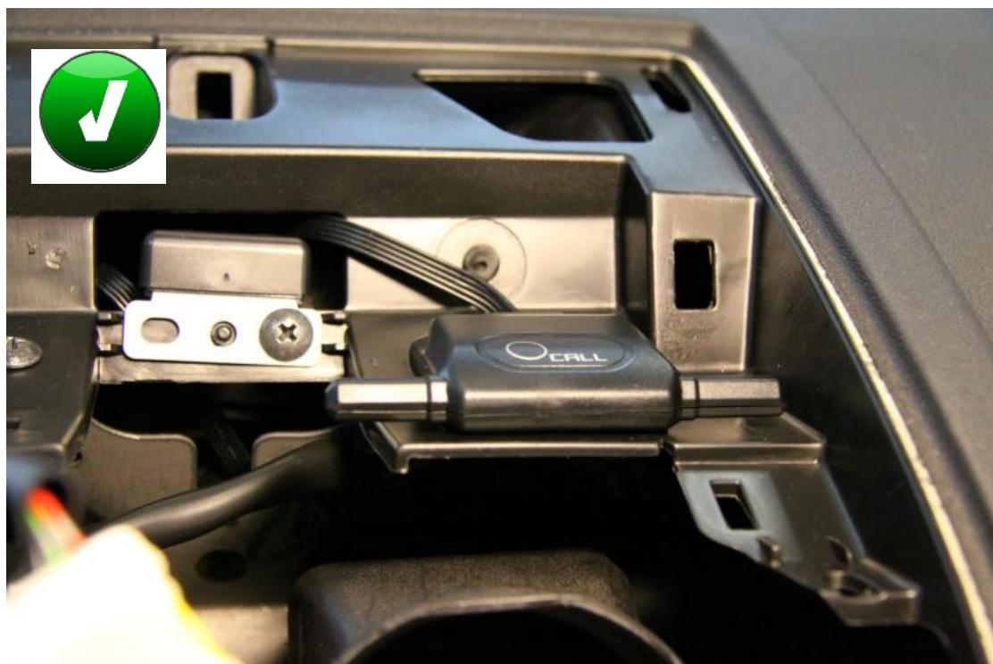
Рисунок 140. Модуль приемопередатчика под накладкой торпеды
