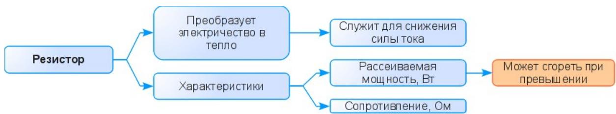
*Рисунок 21. Схема-подсказка "Резистор"*
