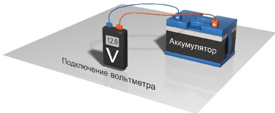
*Рисунок 6. Включение вольтметра*
