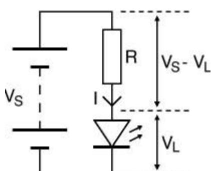
Рисунок 47. Подключение светодиода
