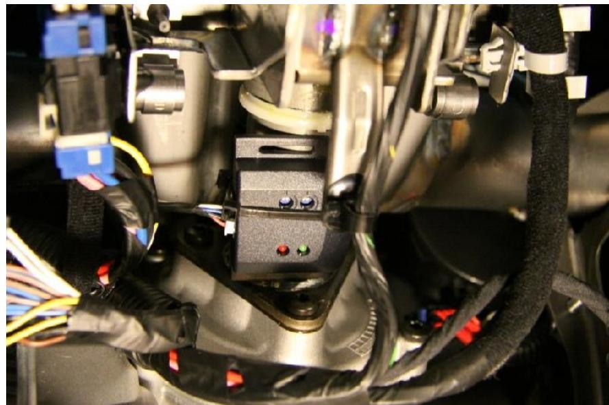
*Рисунок 132. Установка датчика удара на основании рулевой колонки*
