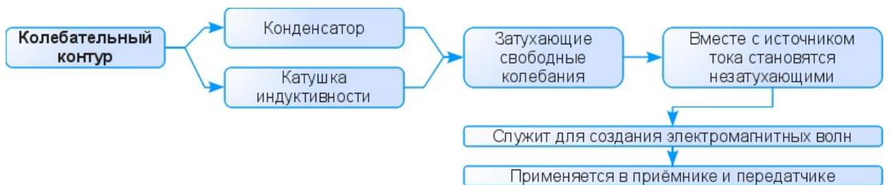
Рисунок 75. Схема-памятка "Колебательный контур"
