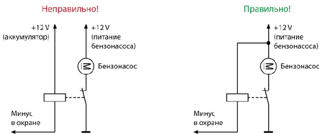
Рисунок 68. Схема блокировки
