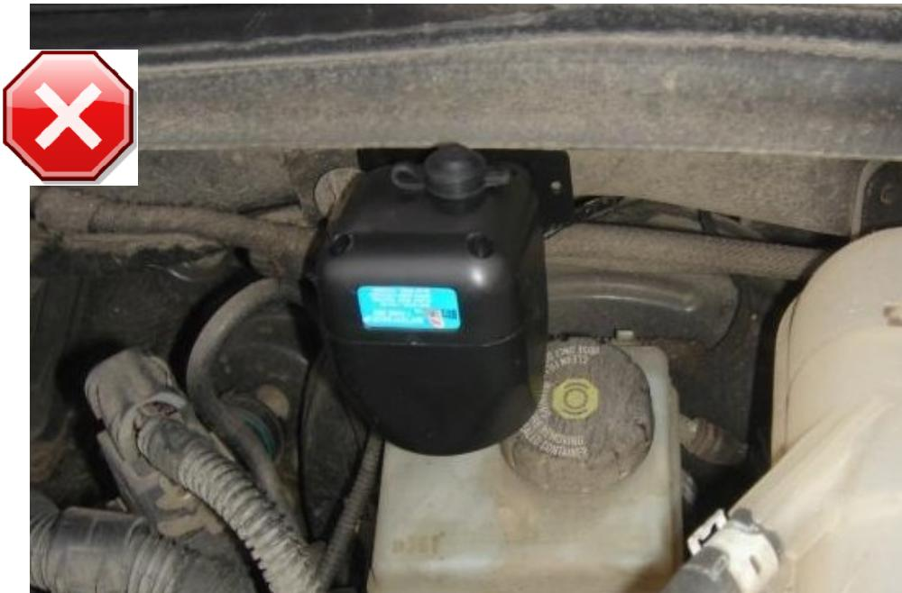
Рисунок 135. Сирена, перекрывающая крышку бачка
