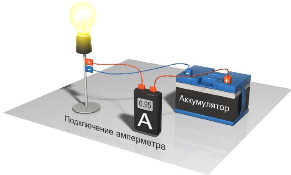
*Рисунок 5. Включение амперметра*
