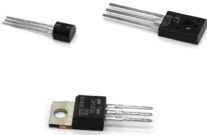
*Рисунок 51. Виды корпусов биполярных транзисторов*
