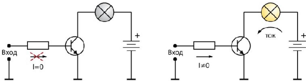
Рисунок 57. Работа транзистора в качестве ключа
