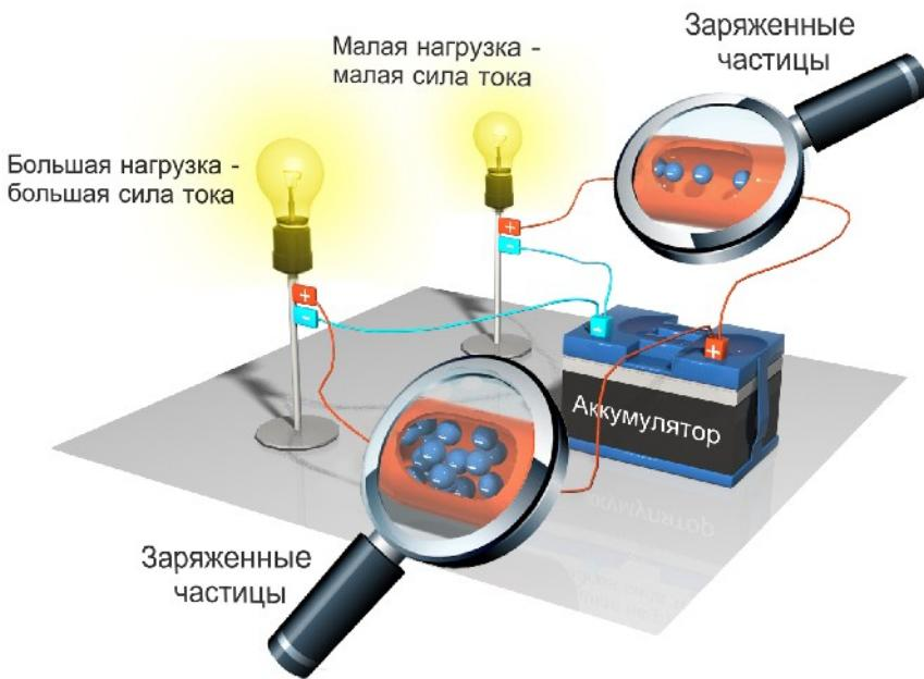
*Рисунок 4. Нагрузка и сила тока*
