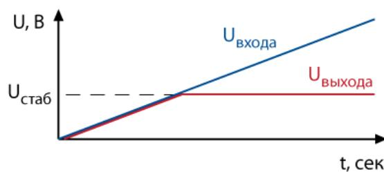
*Рисунок 43. Использование стабилитрона для стабилизации выходного напряжения*
