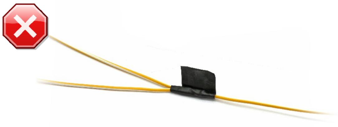
*Рисунок 148. Некачественная изоляция соединения*
