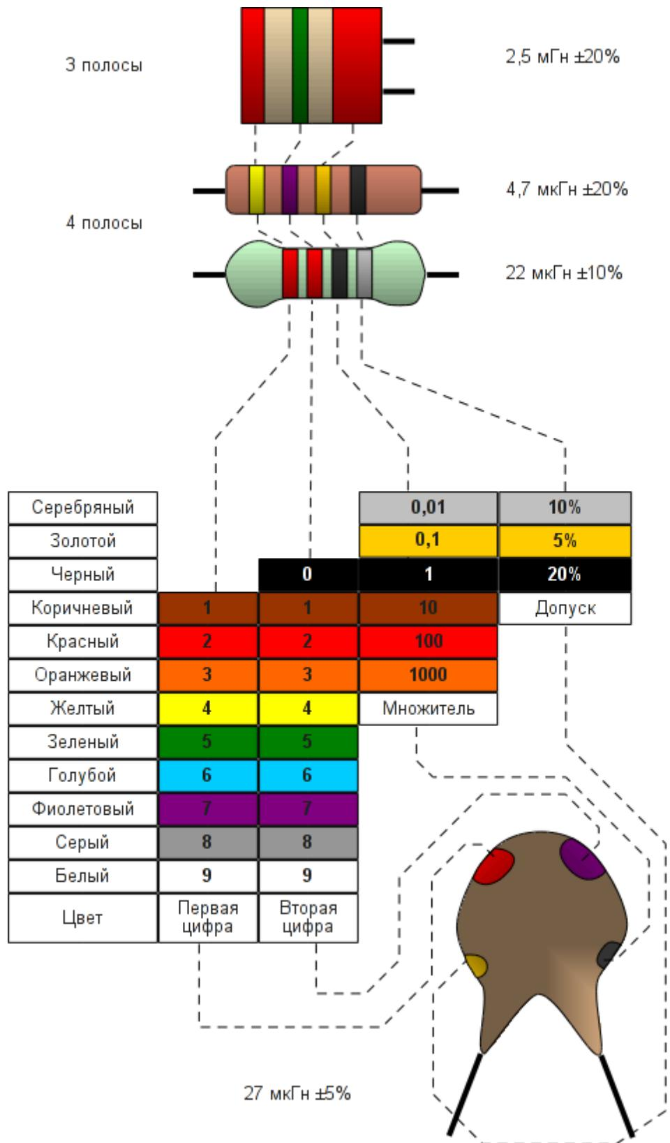
*Рисунок 34. Расшифровка обозначения катушек индуктивностей*
