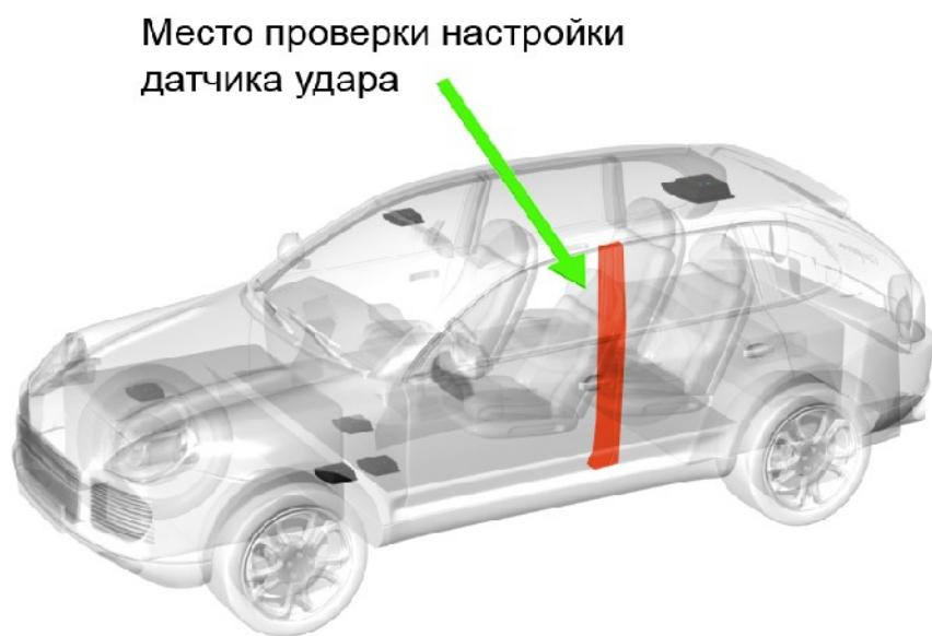
*Рисунок 182. Точка проверки настройки датчика удара*
