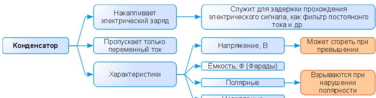
*Рисунок 31. Схема-подсказка "Конденсатор"*
