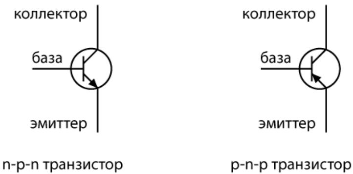
*Рисунок 52. Типы биполярных транзисторов*
