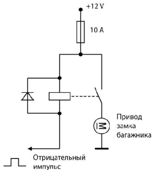
Рисунок 67. Использование дополнительного реле для отпирания багажника
