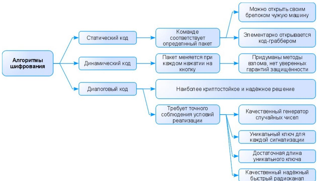
Рисунок 102. Схема-памятка "Алгоритмы шифрования"
