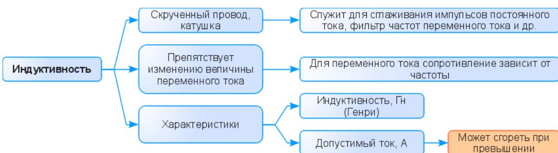
*Рисунок 37. Схема-подсказка "Индуктивность"*
