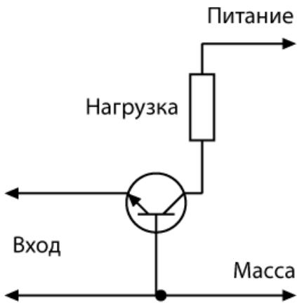
Рисунок 55. Схема включения биполярного транзистора «общая база»
