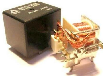
Рисунок 60. Устройство реле
