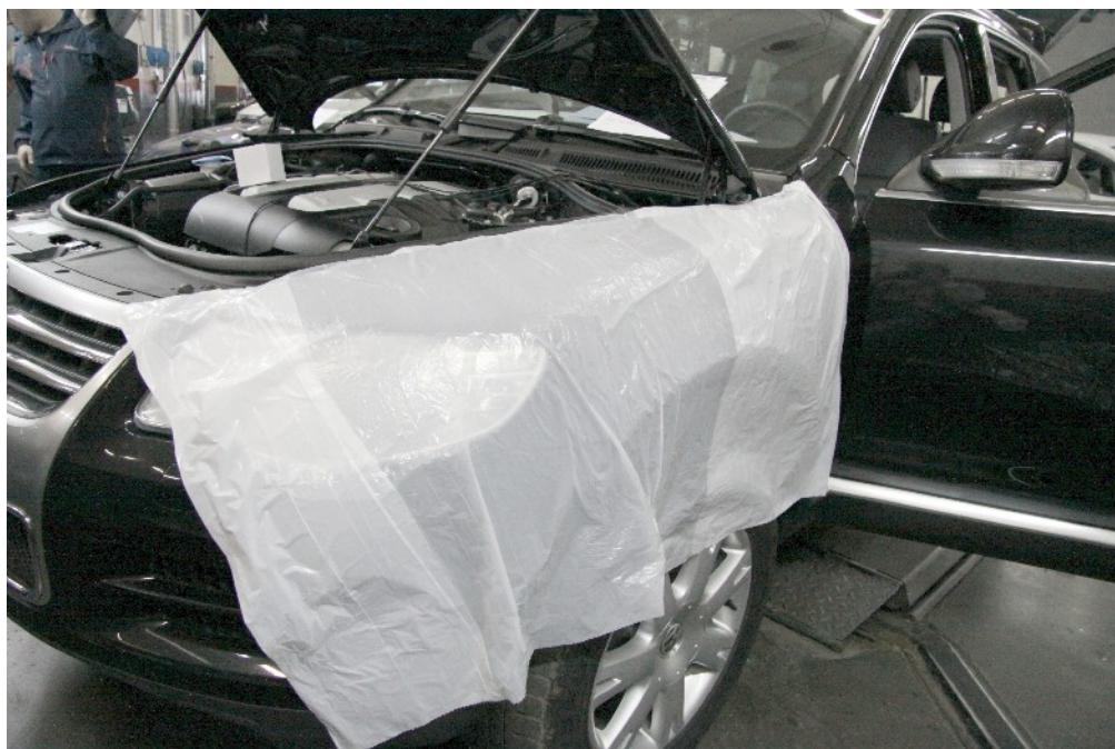
*Рисунок 179. Защита крыльев автомобиля*
