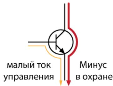
*Рисунок 50. Транзистор управляет большим током при помощи малого*
