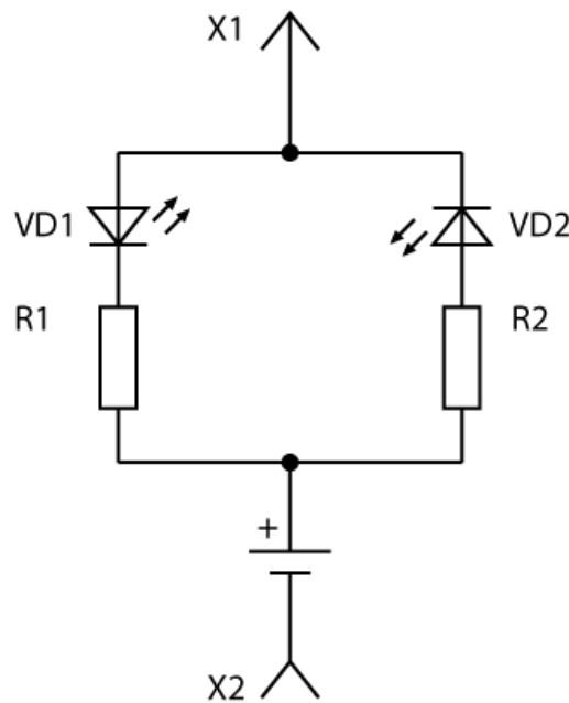
Рисунок 173. Схема пробника
