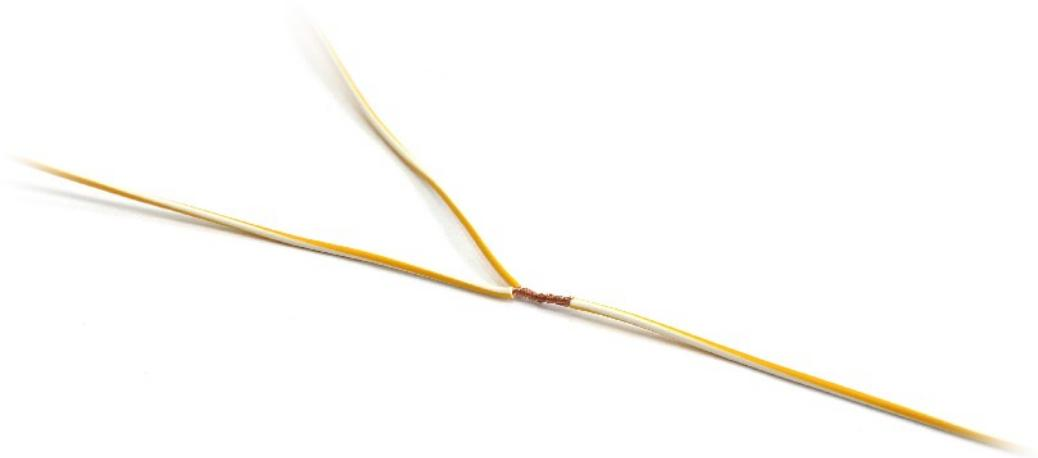
Рисунок 146. Скрутка первого и второго провода
