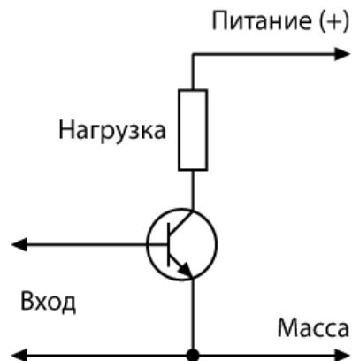
*Рисунок 54. Схема включения биполярного транзистора «общий эмиттер»*
