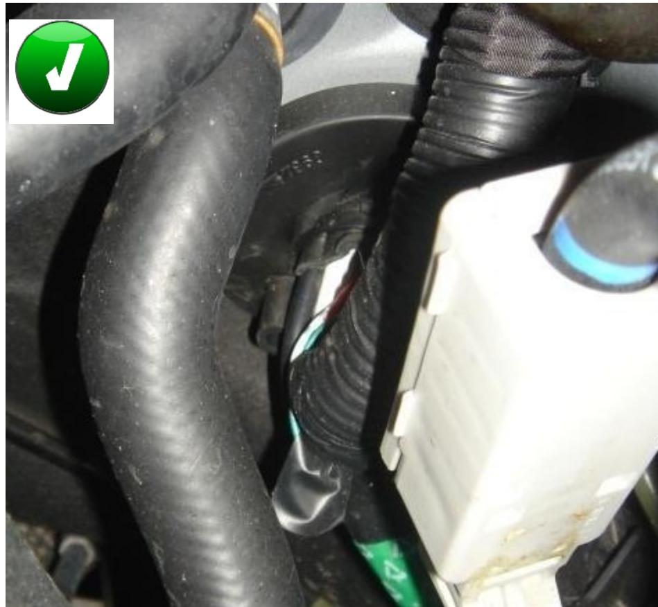
*Рисунок 128. Проложенный через штатное отверстие жгут*
